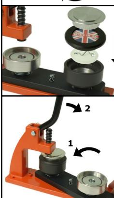
Para chapas de 25 mm con trasera abierta inserta el imperdible de cobre con forma de D.
