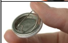
Nel caso di un disco di 25 mm inserire una spilla a "D" in rame.
